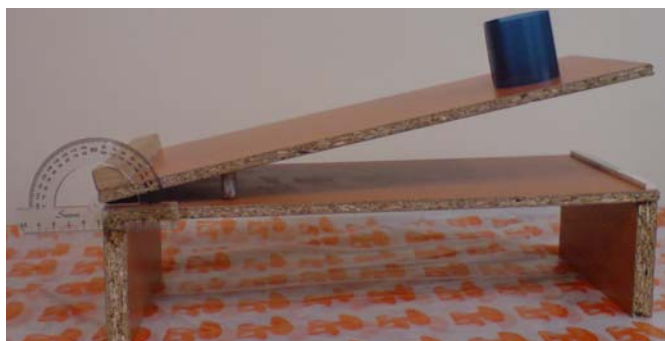
شکل ۱- سطح شیب‌دار جهت اندازه‌گیری ضریب اصطکاک استاتیکی (Sitkei, 1986)
