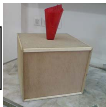
شکل ۲- مکانیزم اندازه‌گیری زاویه استقرار دینامیکی دانه‌ها (Sitkei, 1986)
